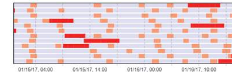
Wärmepumpen Einzelschalthandlungen der Wärmepumpen in 12 Häusern (■ Warmwasser, ■ Heizung)
