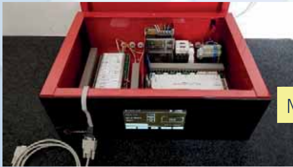
Steuerplatine einer Weider-Wärmepumpe im Simulationsmodus
